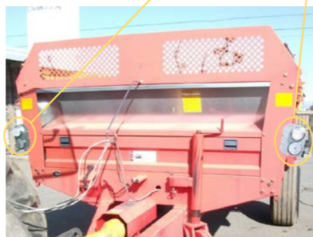
後部反射器及び灯火器類の設置例
