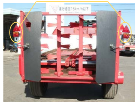
後部反射器及び灯火器類の設置例
